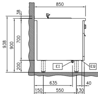
EI = Conexión eléctrica (energía)
